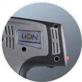
Коробка передач промышленного класса LION GUN приводится в действие при помощи бесщеточного двигателя постоянного тока, что позволяет добиться необходимого крутящего момента быстрее и точнее по сравнению с ручными гаечными ключами, ударными гайковертами и другими инструментами для затяжки.
