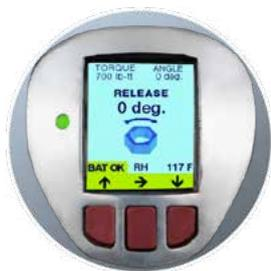
Встроенная функция записи данных позволяет пользователю вести журнал всех выполненных затяжек. Для улучшения контроля качества и подотчетности, информация может быть сохранена на ПК или планшете, чтобы обеспечить постоянный учет выполненной работы.
