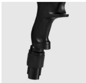
JGun DIGITAL – это уникальный в своем роде инструмент со встроенным регулятором воздушного потока, обеспечивающим регулировку крутящего момента простым поворотом разъема в нижней части ручки. Механизм особенно удобен при переключении с затягивания на ослабление, что позволяет быстро перейти на полную мощность, необходимую для отвинчивания.
