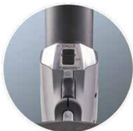
Две скорости вращения. С помощью простого переключателя Lithium Gun выбирает режим высокой скорости для свободного прогона гайки по резьбе, либо режим затяжки контролируемым моментом, исключая необходимость применения двух инструментов. Прецизионный редуктор обеспечивает постоянную мощность без вибраций и шума, в отличие от ударных гайковертов. Крутящий момент устанавливается на дисплее с помощью кнопки на тыльной стороне инструмента.
