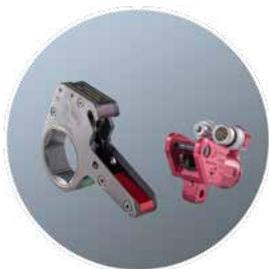
Серия XLCT оснащена храповым механизмом Zero-Slip, обеспечивающим более эффективное отвинчивание и более быстрое затягивание. Дополнительная собачка внутри инструмента предотвращает вращение храповика в обратном направлении.
