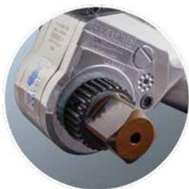
Устройство ICE может автоматически высвобождаться при блокировке на болте. Это позволяет уменьшить количество незапланированных срывов в процессе работы с болтовыми соединениями.
