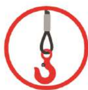
работа при отсутствии защелки на крюках
